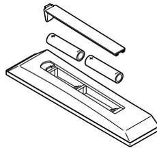
Nehmen Sie die Batterieabdeckung ab, so dass das Batteriefach sichtbar wird, und legen Sie die Batterien mit der richtigen Polarität ein. Geeignete Batterietypen für diese Fernbedienung sind AAA, IEC R03 mit jeweils 1,5 V.
