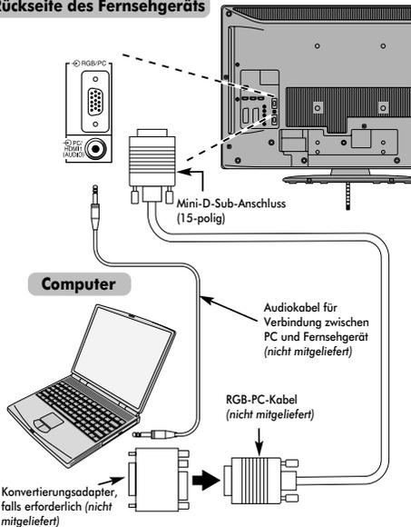
Stellen Sie am PC die Monitorausgangsaufösung ein, bevor Sie den PC an das Fernsehgerät anschließen. Geeignete PC-Signal-Formate finden Sie auf Seite 48.
