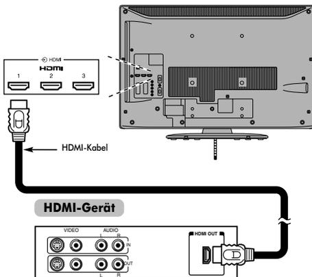
Zum Anzeigen der Videosignale vom HDMI-Gerät drücken Sie die -Taste, um den Modus HDMI 1, HDMI 2, HDMI 3 oder HDMI 4 auszuwählen.
